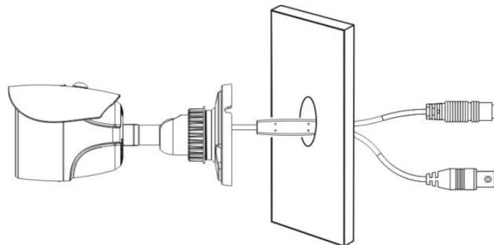
Verwenden Sie die mitgelieferten Schrauben um den Fuß fest mit der Decke oder der Wand zu verbinden.
